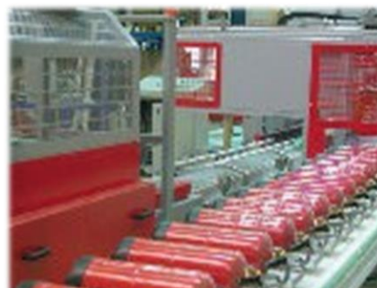
Encaissage et palettisation d'extincteurs.
